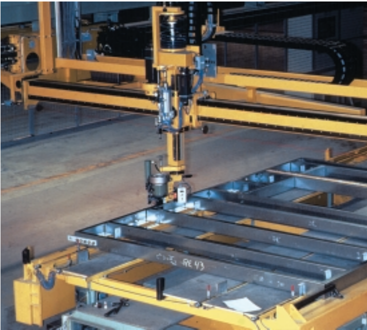
Abb. 46: Roboter-gesteu- erte Wandtafel- fertigung bei Rautaruukki Oyj (Finnland)
